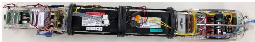
ASV制御用電子回路(耐圧容器内部)
